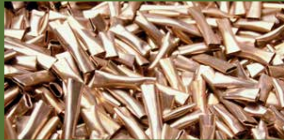
Coques issues des gaines en alliage de zirconium qui enrobent les pastilles de combustible
