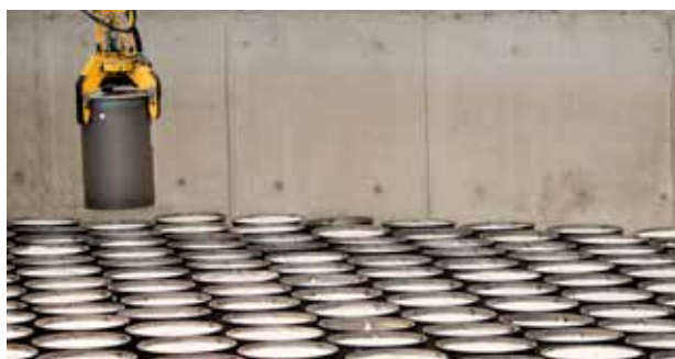
Stockage de colis de déchets FMA-VC au Centre de stockage de l'Aube
